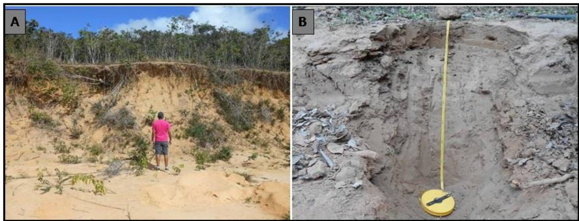
Figura 02 – (A) Perfil de Latossolo no município de Tianguá; (B) Perfil de Neossolo Flúvico próximo ao rio Coreaú.
